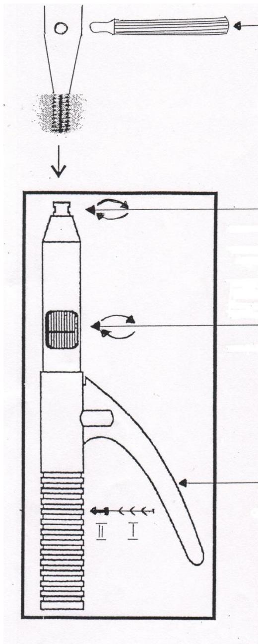
Přístroj k utahování/povolovaní koncovek snímače
